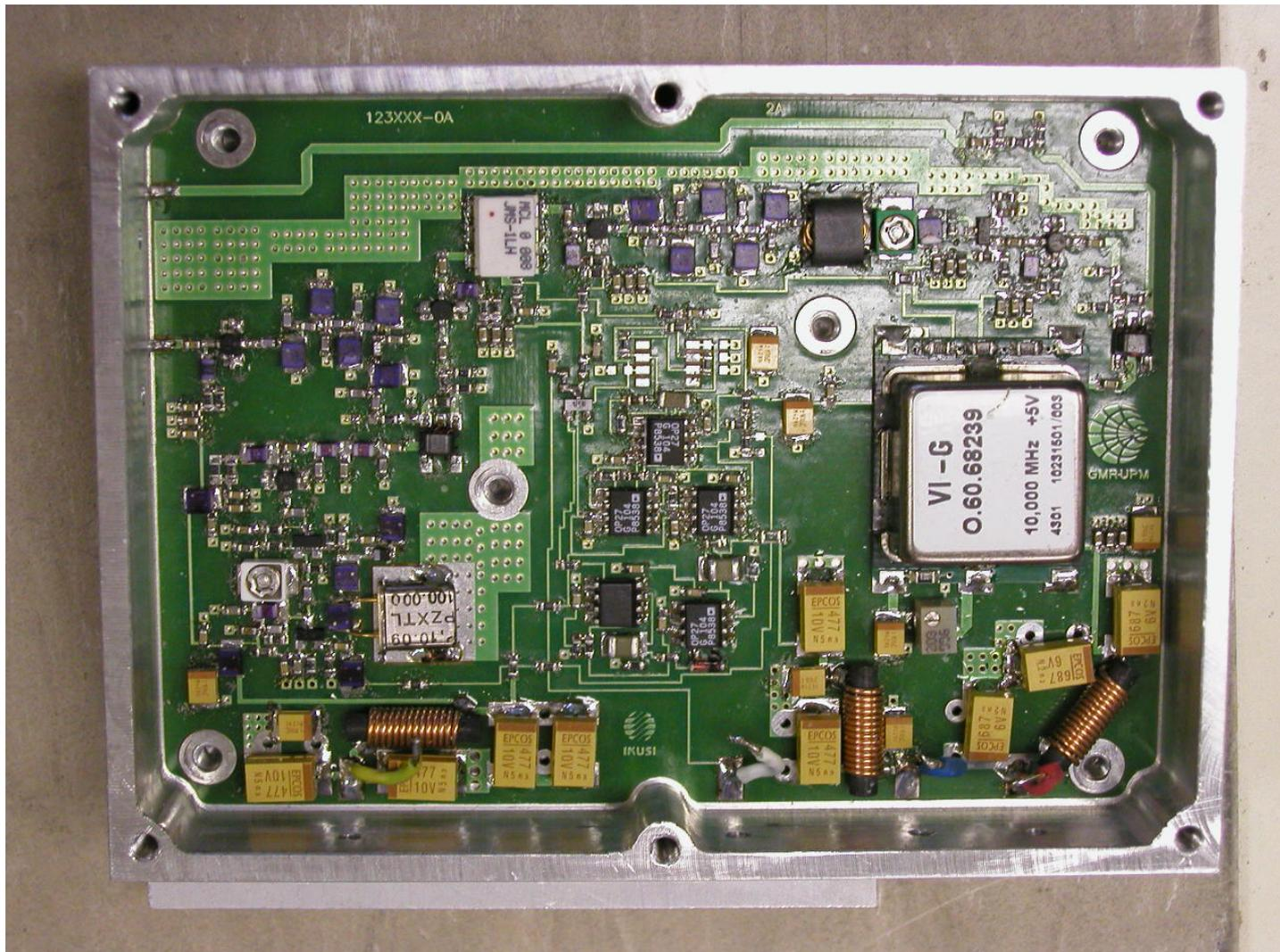
Referencia de ultra bajo ruido: VCXO 100 MHz enganchado a XTAL de 10 MHz
